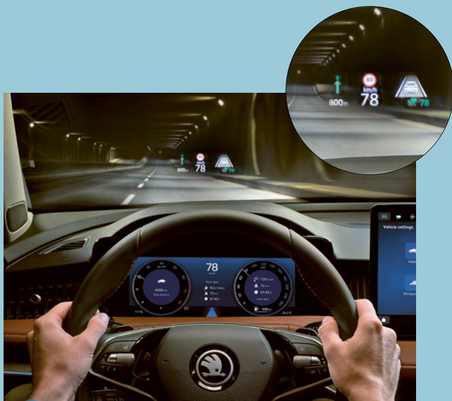
OCCHI SULLA STRADA ▲ Il display head-up proietta le informazioni importanti direttamente sul parabrezza.
